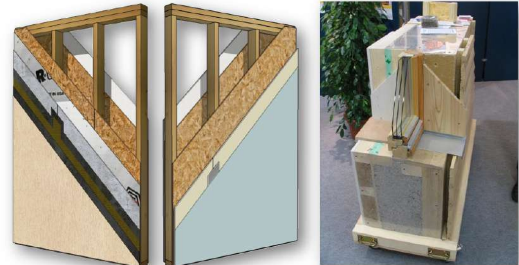
Figura 2 - Camadas de parede
