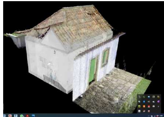
Figura 2 - Forte Santana - Próximo à Ponte Hercílio Luz – Nuvens de pontos.
